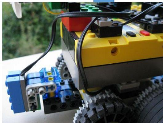
Lorsqu'il passe devant, le robot coupe le faisceau, et le récepteur ne reçoit plus de lumière.
