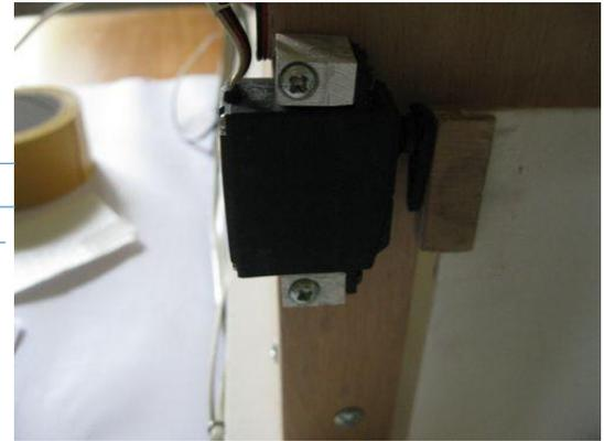
**Le servomoteur tournera lorsque la sortie sera mise à +5V par l'Arduino**
