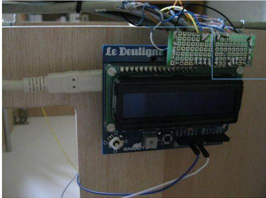
C'est en mettant la SORTIE sur laquelle est connecté le servomoteur successivement à 0V et +5V (impulsions) que le programme va pouvoir positionner le servomoteur précisément.
