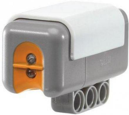
Ce capteur de « lumière » est doté d'une **Diode électroluminescente** qui émet une lumière rouge et d'un récepteur la **photorésistance**.
